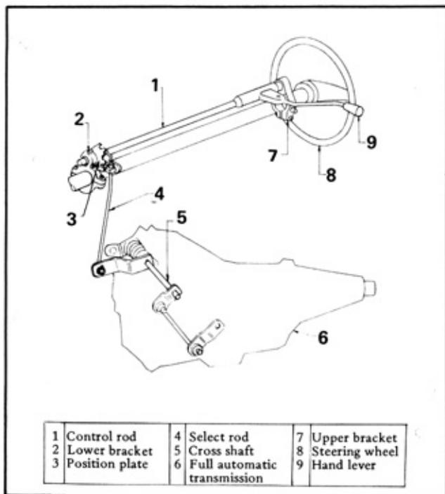
Fig. TM-7 Manual linkage
