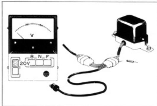
**PERFORMANCE TEST BY ALTERNATOR CHECKER**
