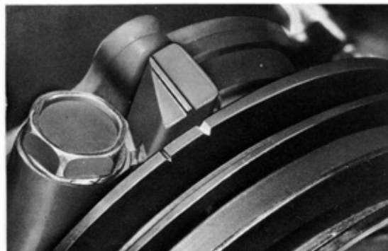
Fig. 3-89 Align 8° BTDC Mark
