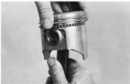
Fig. 3-145 Check Pin Fit
